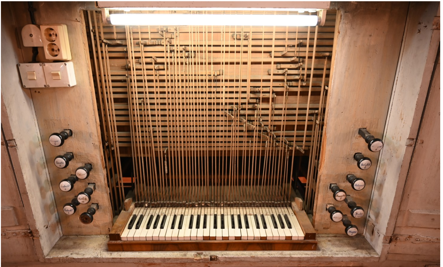
Blick auf den Spieltisch und die originale Spielmechanik, mit den gut erkennbaren Anpassungen der Wellenärmchen zur Herabsetzung der Tonhöhe und 14. statt ehemals 17 Registerzügen.
