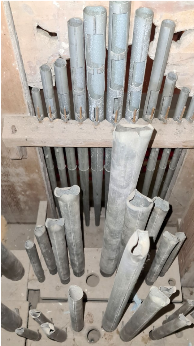
Blick auf die stark restaurierungsbedürftigen Mündungen des Metallpfeifenwerkes
