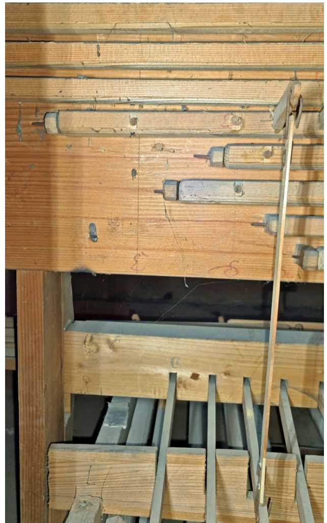
Blick auf den Spieltisch und die originale Spielmechanik, mit den gut erkennbaren Anpassungen der Wellenärmchen zur Herabsetzung der Tonhöhe und 14. statt ehemals 17 Registerzügen.
