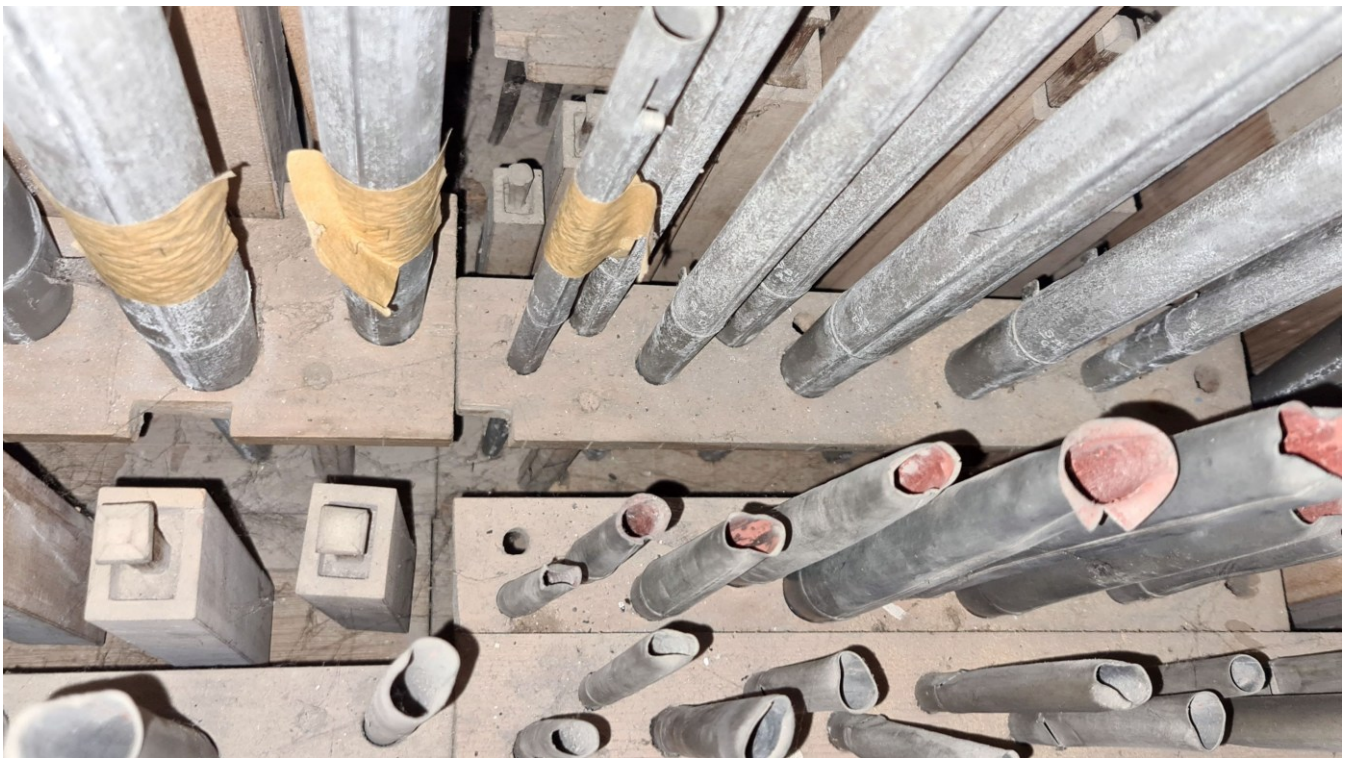
Blick auf das Pfeifenwerk des Salicional 8' (mit Klebeband, Zink, stark oxidiert) Kleingedackt 4' und Superoctav 2'
