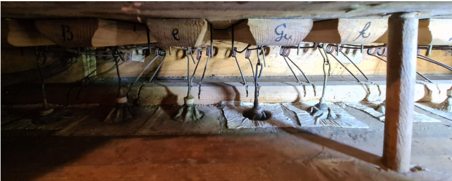
Blick in den Windkasten, die Spielventile und die Lederpulpeten
