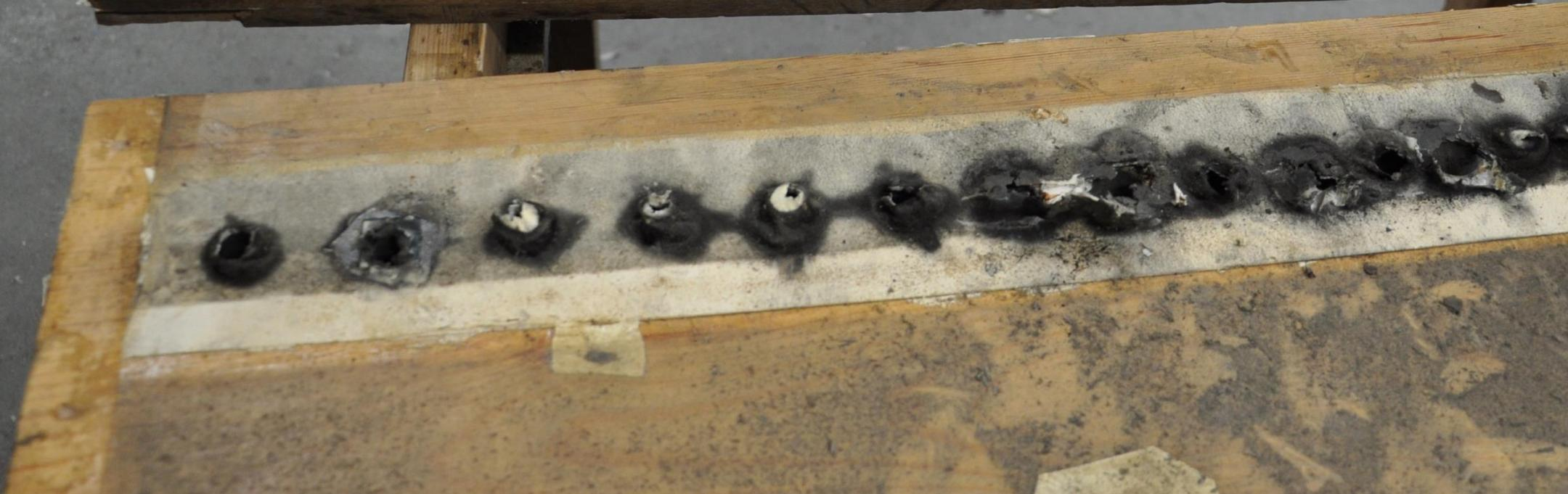
Blick in den Windkasten nach dem Ausbau der Spielventile
