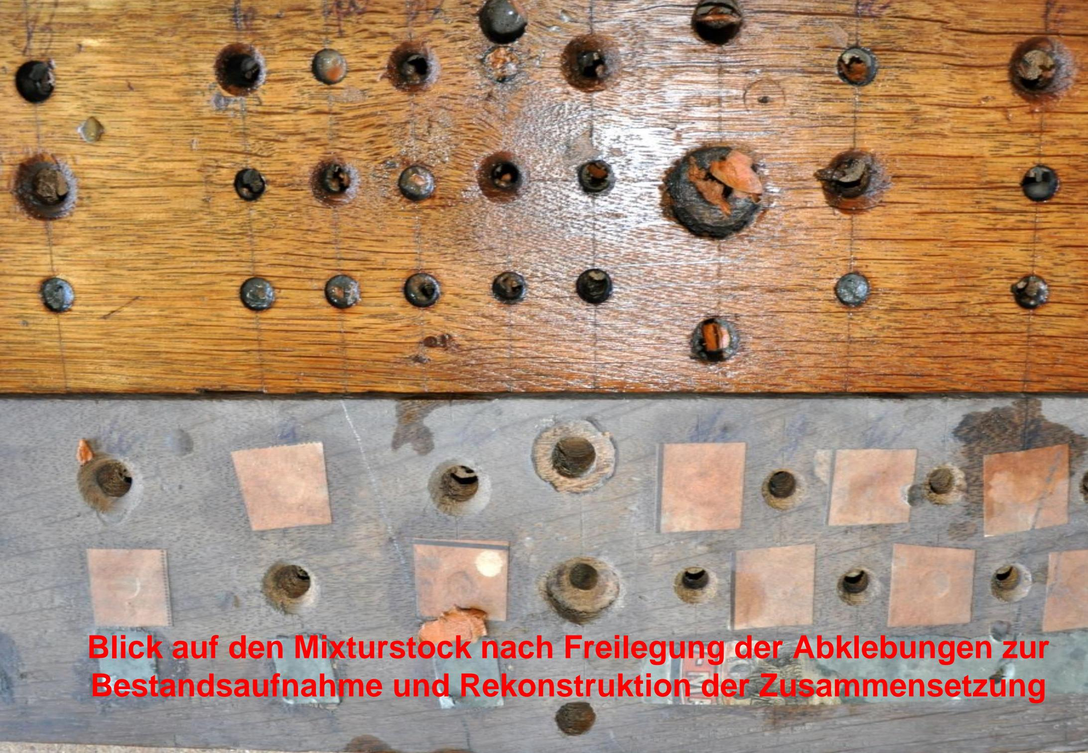
**Blick auf den Mixturstock nach Freilegung der Abklebungen zur Bestandsaufnahme und Rekonstruktion der Zusammensetzung**
