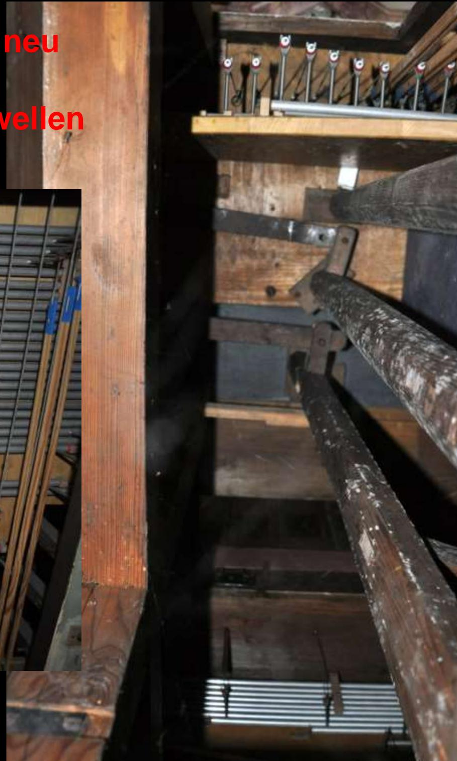
**Blick auf die Pedaltraktur und den Schutzkasten des elektrischen Winderzeugers**
