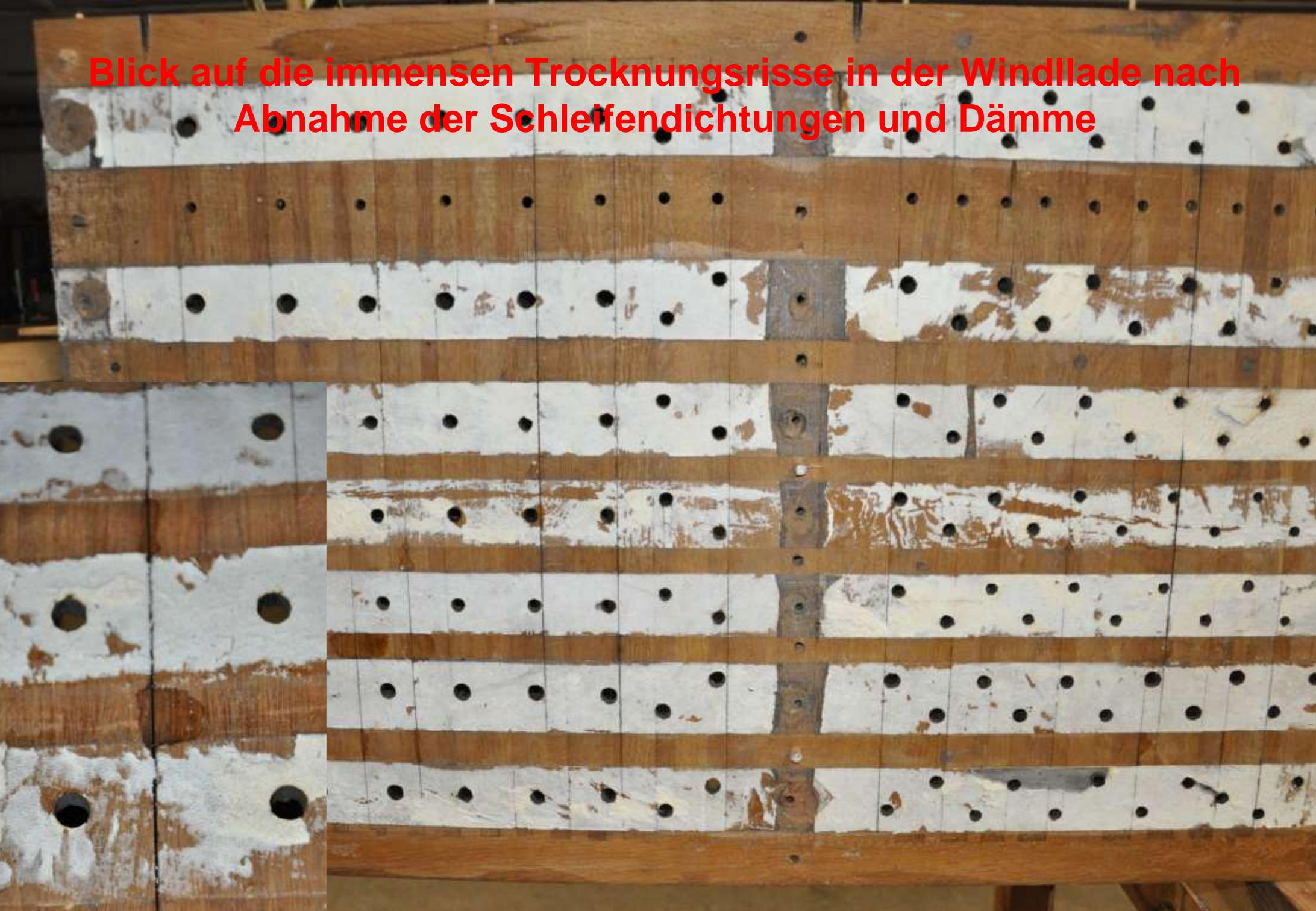
**Blick auf die Windlade nach dem Ausspänen der Trocknungsrisse**
