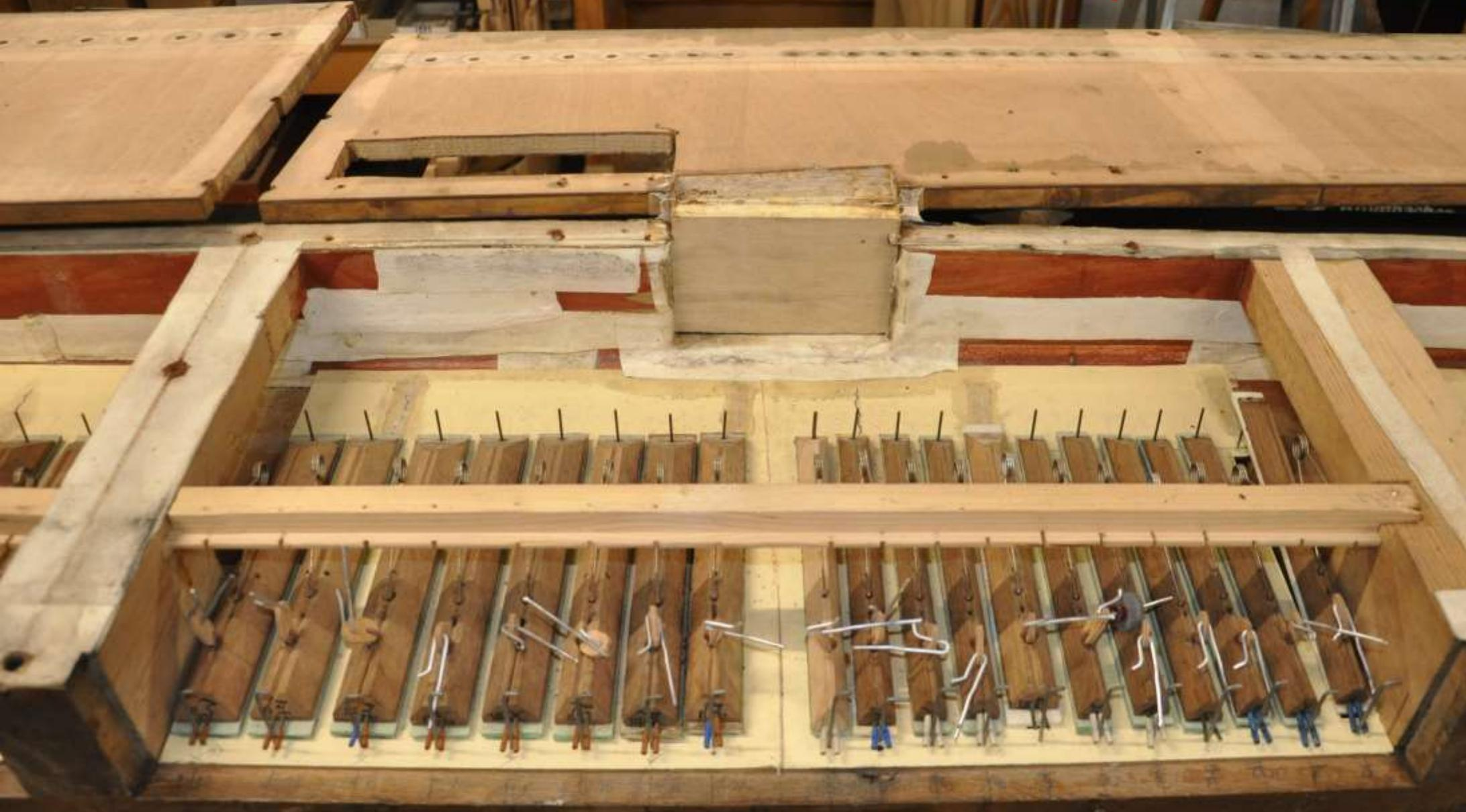
**Blick in den Windkasten nach dem Ausbau der Spielventile**
