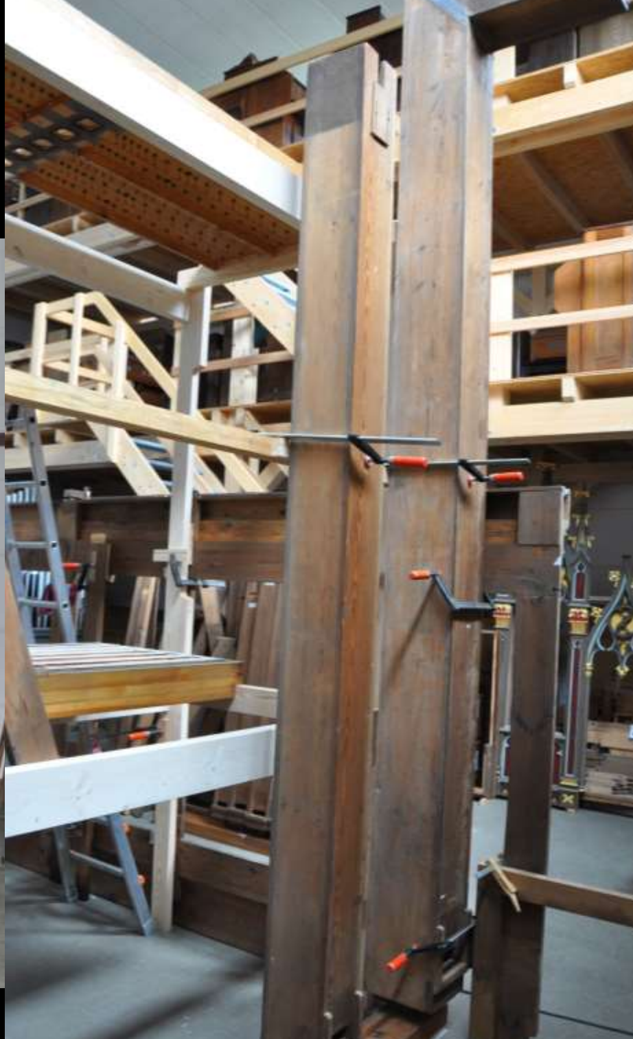
Neukonstruktion der Orgelanlage mit Einbau eines Schwellwerkes und Integration des Prinzipalbass 16' stehend in das Orgelgehäuse
