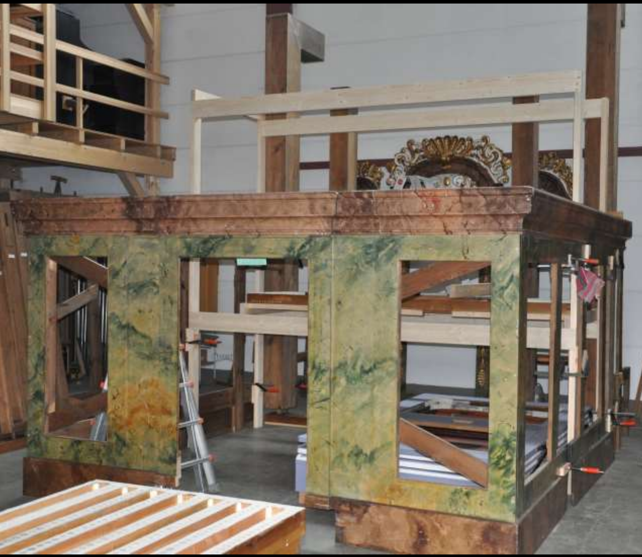
Neukonstruktion der Orgelanlage mit Einbau eines Schwellwerkes und Integration des Prinzipalbass 16' stehend in das Orgelgehäuse
