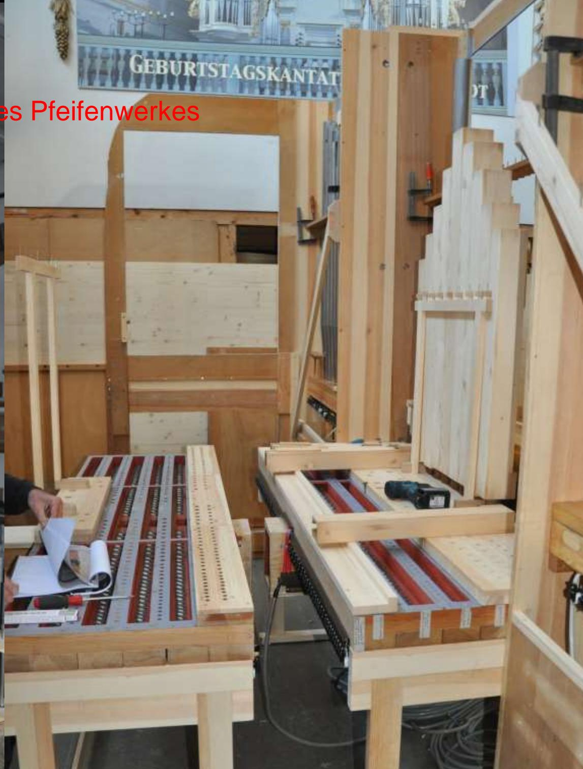
Blick in geöffnete Registerkzanzellen mit den Kegelventilen
