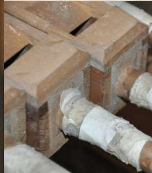
Originales Register Floete douce 4', konische Bauart mit schrägen Labien in der Basslage, Material Fichte / Elsbeere
