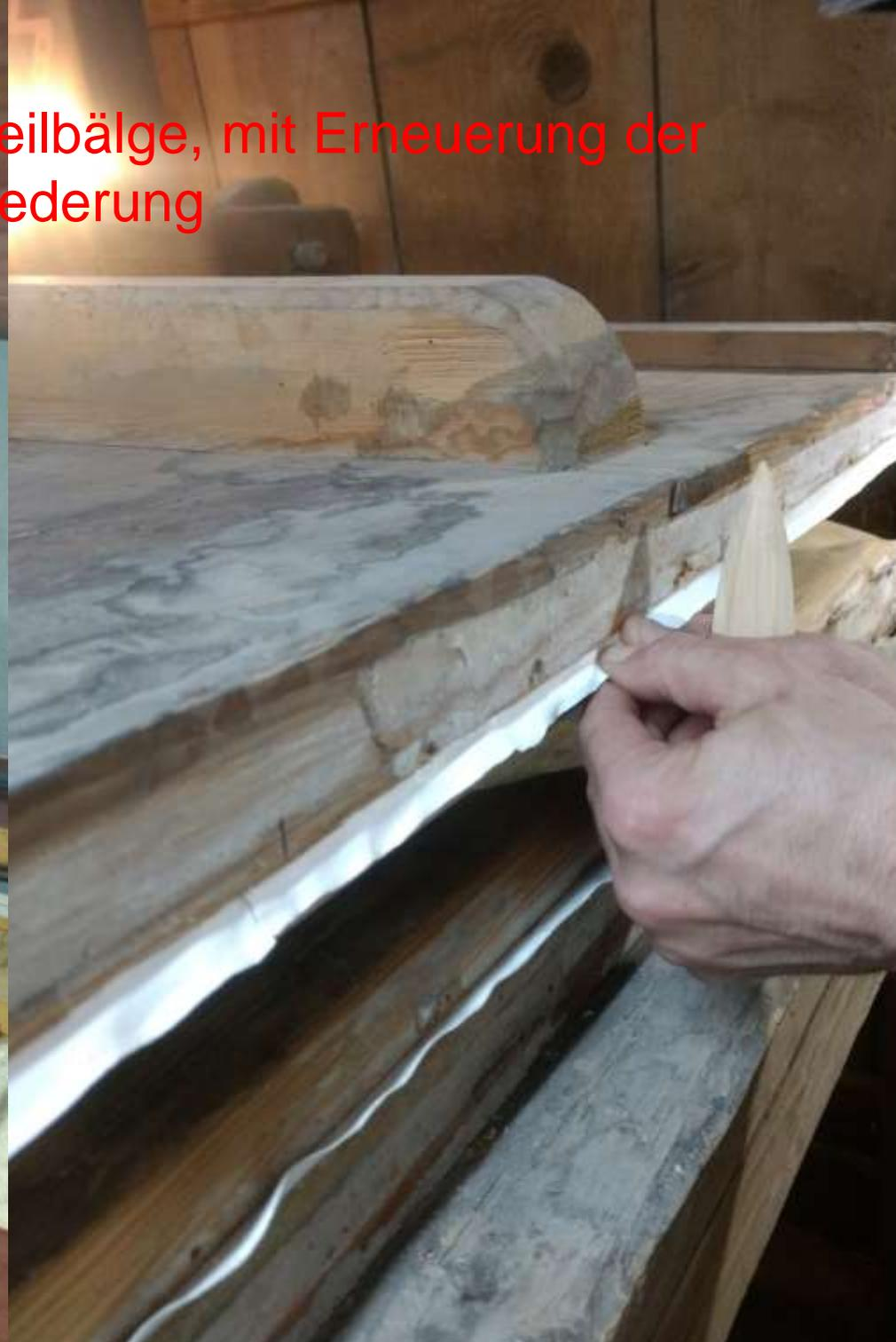
Blick in den Blasebalg nach dem Ausbau der Balgfolien
